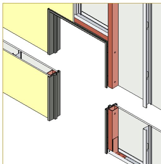
\* Los puentes del marco de carpintería se fijarán mediante tornillos T1 punta aguja a un refuerzo realizado con tubo de 70mm x 40mm, con ángulos L en los extremos que permitirán fijarlo a los perfiles Solera inferior y superior.
