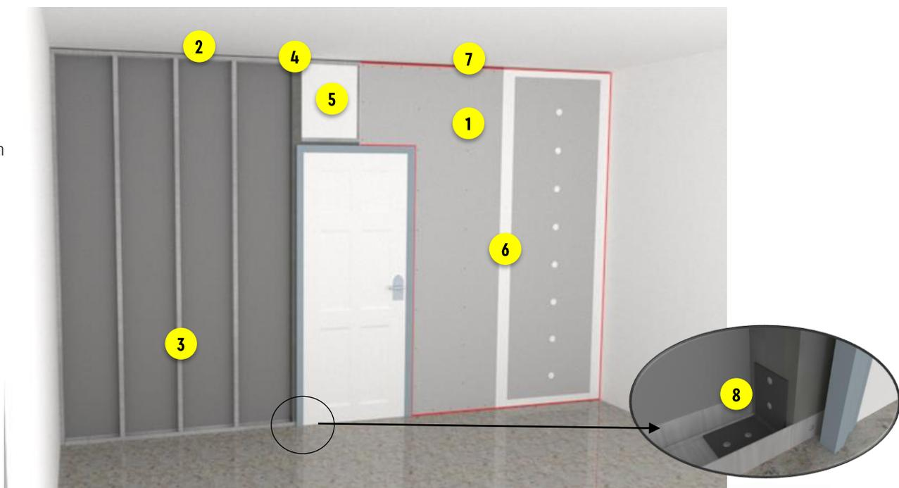
La colocación de carpinterías en paredes Durlock® debe realizarse previamente al emplacado. Los marcos metálicos especiales para Sistema de Construcción en Seco, se proveen con tres puentes en ambas jambas, que permiten fijarlos al perfil Montante extremo de la estructura y con un ángulo L inferior en cada jamba, que permitirá realizar la fijación de la carpintería a la Solera inferior y al piso. En caso de colocar marcos metálicos estándar, se deberán soldar tres grampas en ambas jambas.
