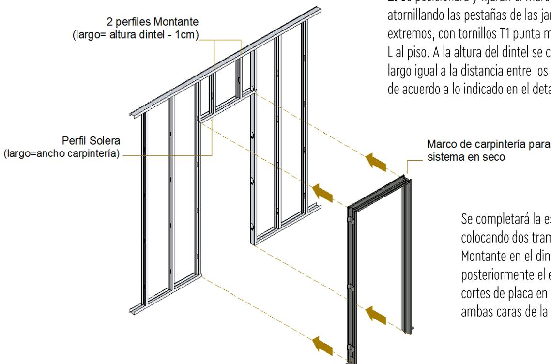
**2.** Se posicionará y fijarán el marco de carpintería atornillando las pestañas de las jambas a los Montantes extremos, con tornillos T1 punta mecha y fijando los ángulos L al piso. A la altura del dintel se colocará un perfil Solera de largo igual a la distancia entre los dos Montantes extremos, de acuerdo a lo indicado en el detalle.
