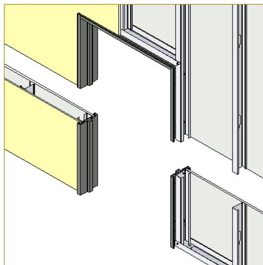
\* Los puentes del marco de carpintería se fijarán mediante tornillos T1 punta mecha a un refuerzo realizado con un perfil estructural de chapa galvanizada tipo PGC de 70mm x 0,89mm.
