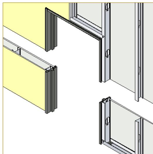
\* Los puentes del marco de carpintería se fijarán mediante tornillos T1 punta aguja a un refuerzo realizado con dos perfiles Montante de 69mm que conforman un tubo de 69mm x 35mm.
