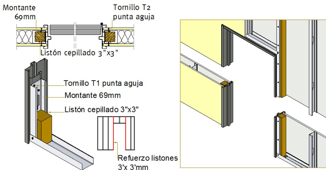
\* Los puentes del marco de carpintería se fijarán mediante tornillos autoperforantes para madera a un refuerzo realizado con listones cepillados de 3'x 3'.
