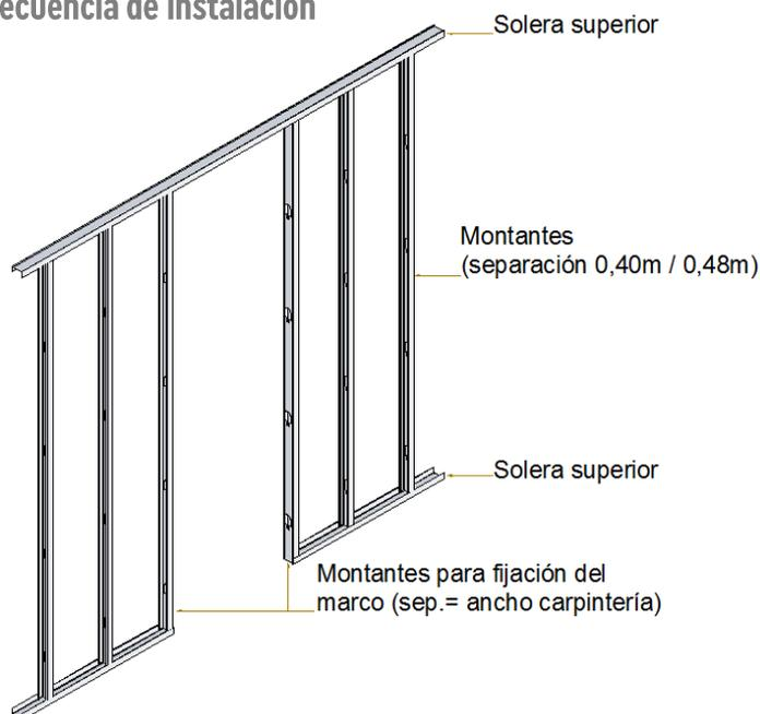
**1.** La estructura de la pared se armará colocando los perfiles Solera inferior y superior, se completará con los perfiles Montante colocados con una separación de 0,40m ó 0,48m. La Solera inferior de la estructura se colocará de manera que quede libre el espacio correspondiente al ancho de la carpintería a colocar. Se dejarán previstos dos perfiles Montante extremos a los que se fijará el marco.
